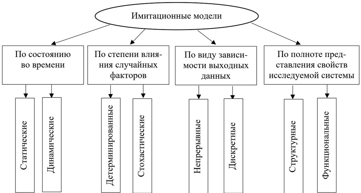
*Рис. 5.1.1. Классификация имитационных моделей*
